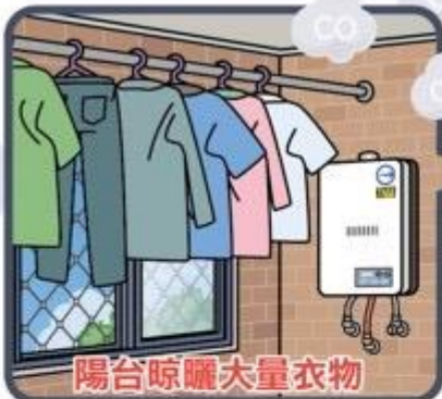
屋外式瓦斯熱水器 安裝在室內
